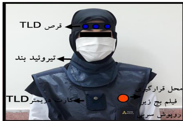
شکل ۱: نمونه‌ی نصب و مکان دزیمترهای TLD و فیلم‌بیج بر روی بدن یک پرتوکار
